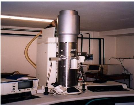
Microscopio elettronico a trasmissione
